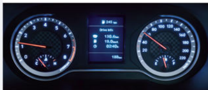
Cluster conventionnel avec écran LCD TFT 3,5"
